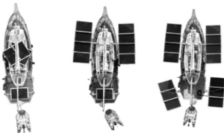
Die Sonnensegel von *Ulla* lassen sich innerhalb von knapp 10 Minuten ausfahren und ergeben dann 28 Quadratmeter Solarfläche mit einer Leistung von beinahe 6000 Watt.
